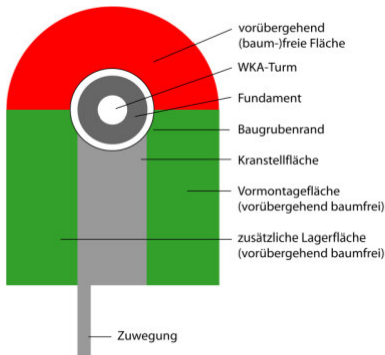
Abb. 1 Schema eines WEA –Standorts
